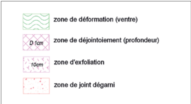
Figure 6a : figurés des désordres spécifiques aux maçonneries de pierres
