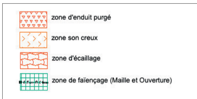
Figure 6c : figurés des désordres communs à tous les revêtements
