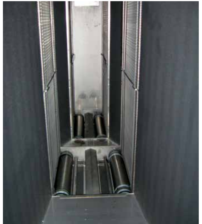
Illustration 24 : filtres électrostatiques montés sur rouleaux afin de faciliter le nettoyage à l'air sous pression (Aigner)
