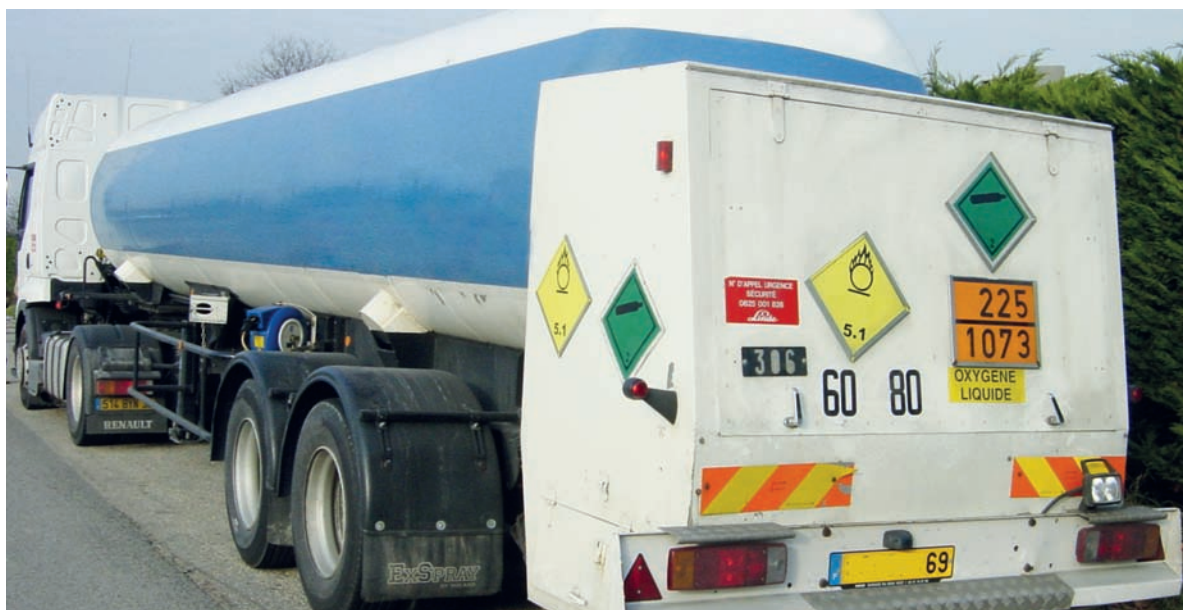
Illustration 1 : Exemple de signalétique de transport de marchandise dangereuse : étiquette verte (gaz), étiquette jaune (matière comburante solide ou liquide), plaque orange (n° ONU indiquant l'oxygène liquide)
