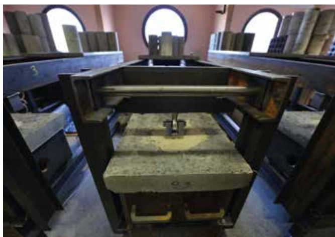
Essai de fluage d'une dalle de béton renforcé de fibres.
