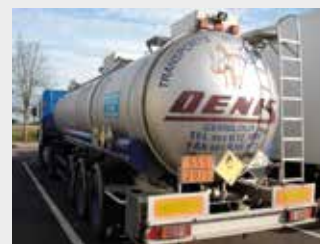
Véhicule de transport de marchandises dangereuses
