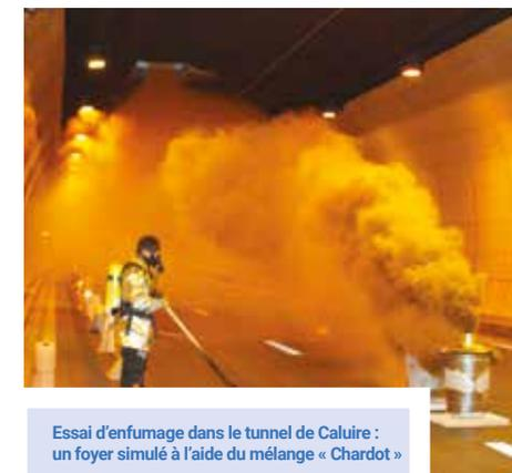
Essai d'enfumage dans le tunnel de Caluire : un foyer simulé à l'aide du mélange « Chardot »
