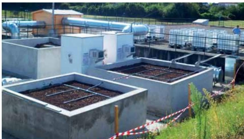
Biotair, expérimentation d'un biofiltre, du projet à la réalisation de l'expérimentation
