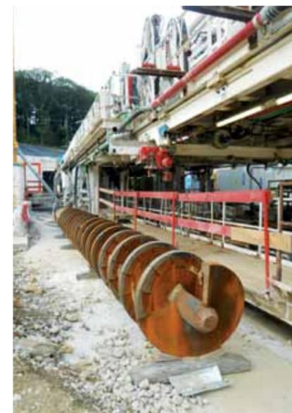
Tramway Viroflay, tunnelier en cours de montage, vis sans fin de marouflage
