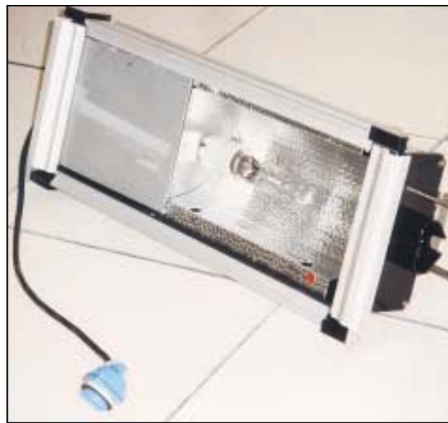
▲ Photo n°18 - Luminaire au sodium haute pression
