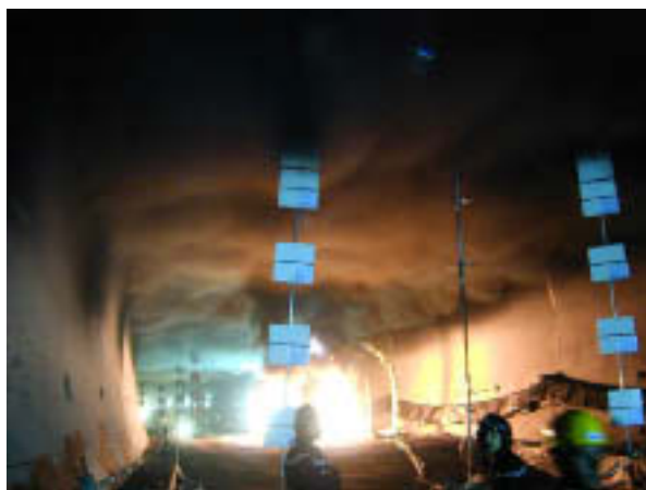
FIG. 2.1 – Exemple de nappe de fumée stratifiée.
