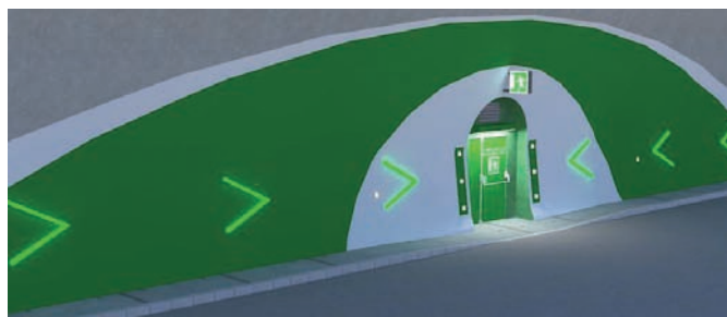
Figure 8 : Exemple de traitement d'une issue de secours avec feux flash et chevrons.
