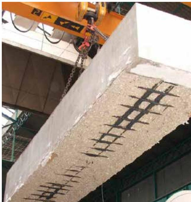
Corps d'épreuve après un essai d'écaillage en four
