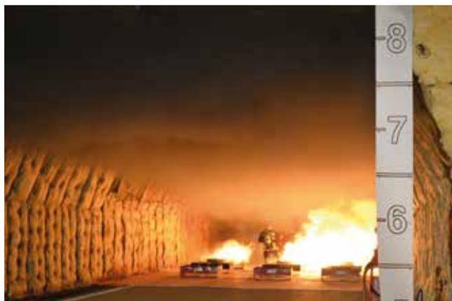
Tube sud du tunnel de Toulon - Essai de fumées chaudes
