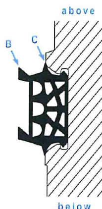
Figure 6 : Insertion du joint dans le moule - (B) Empattement d'ancrage, (C) Lèvre médiane du joint
