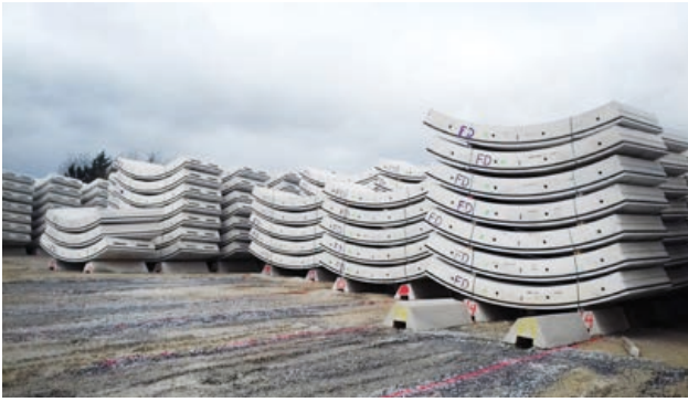
Stockage des voussoirs fibrés définitifs pour le lot 1 de la ligne 16 à l'usine Bonna Sabla à Conflans St Honorine
