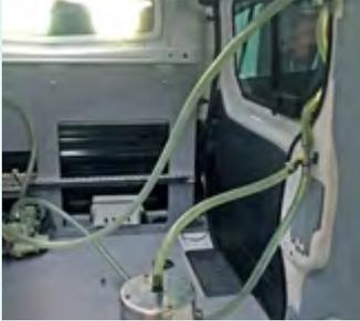
Les mesures de pollution en tunnel, réalisées traditionnellement par l'installation d'un analyseur en un point donné, ne permettent pas de connaître la réelle exposition des usagers, car les niveaux de pollution fluctuent tout au long du tunnel. Pour cette raison, le CETU développe actuellement un véhicule instrumenté destiné
