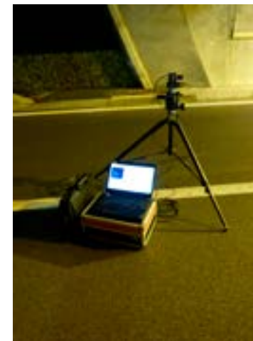
Tunnel de Fontain, mesures avec photoluminancemètre
