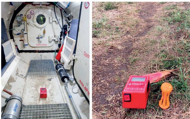
Capteurs utilisés pour les mesures de vibrations
