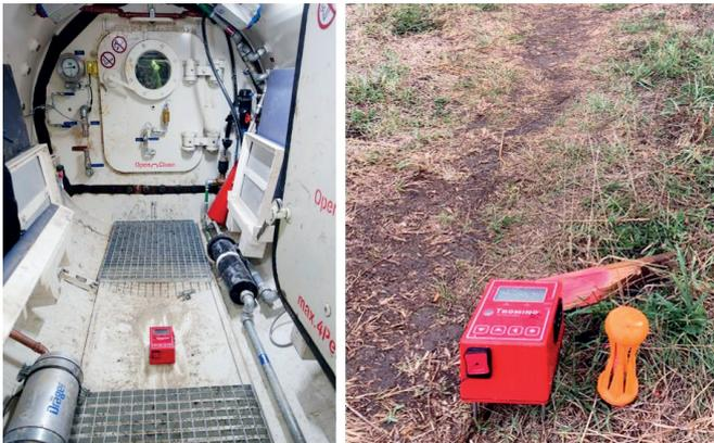
Capteurs utilisés pour les mesures de vibrations
