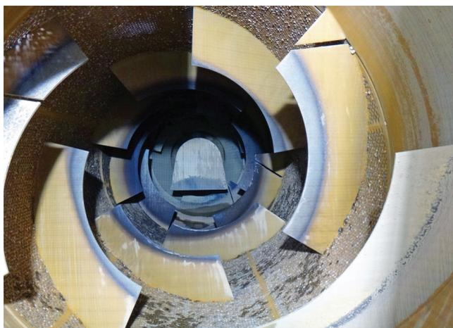
Trommel utilisé pour trier les matériaux excavés (© CETU)
