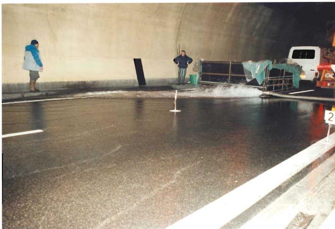
Mise en place du tuyau raccordé au poteau d'incendie pour l'essai en écoulement continu
