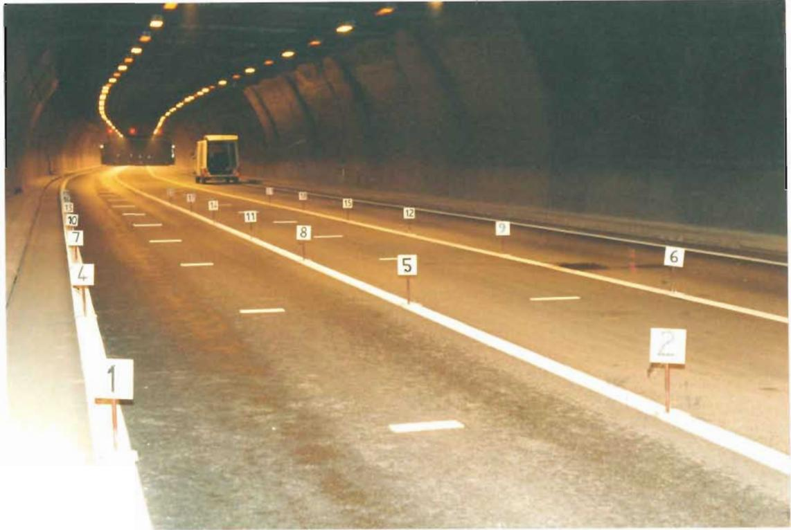
**Quadrillage de la chaussée avec bande réfléchissante et plots numérotés**
