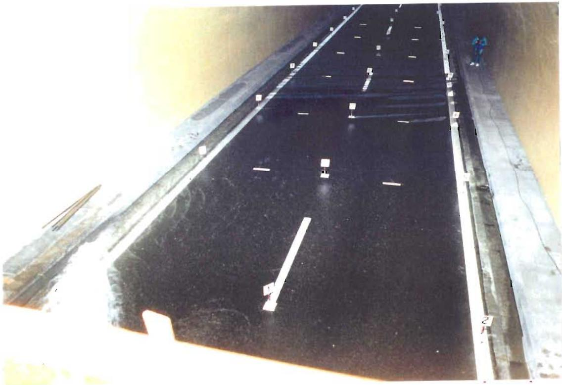
**Surface mouillée avec l'écoulement continu : débit 19 l/s**
