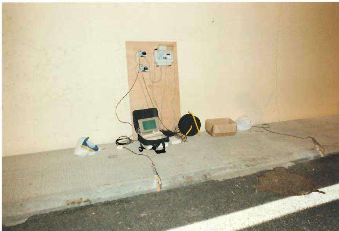
**Mise en place des capteurs en extrémité de caniveau**
