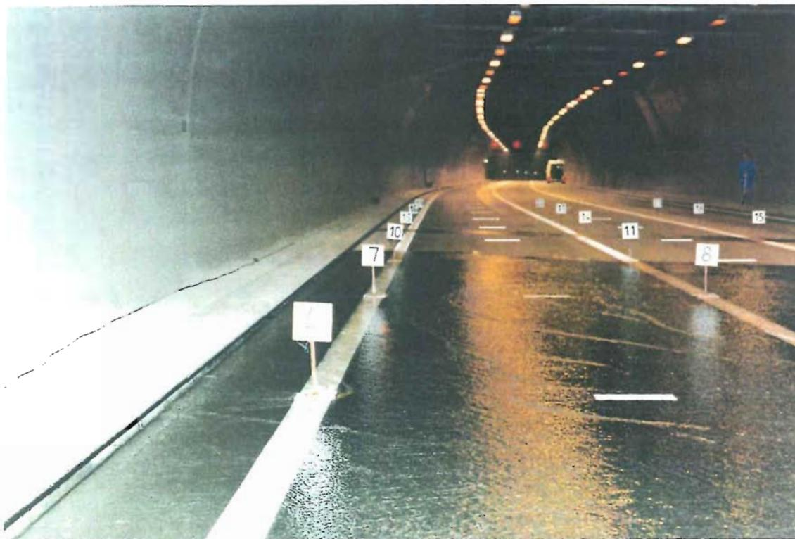
**Etendue de la flaque d'eau au cours de l'essai avec écoulement faible**
