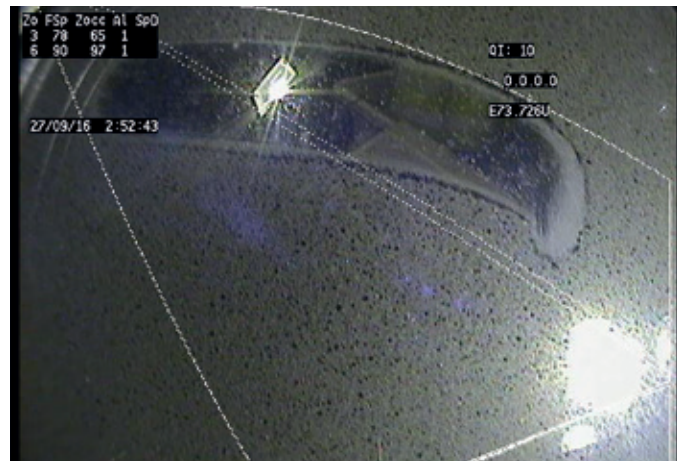
Figure 16 : Mauvaise qualité d'image issue d'une caméra dont la vitre de caisson est encrassée
