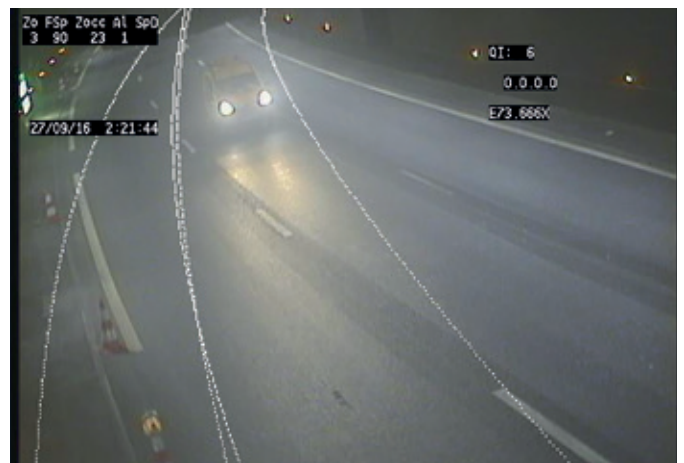
Figure 17 : Flux vidéo d'une caméra ayant bougé (décalage des masques)
