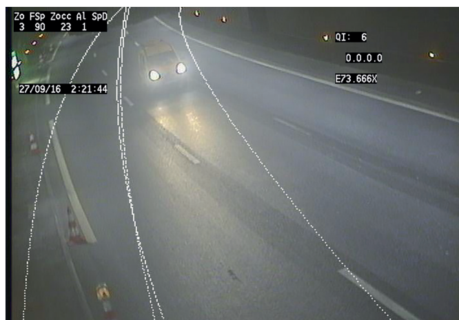
Figure 17 : Flux vidéo d'une caméra ayant bougé (décalage des masques)
