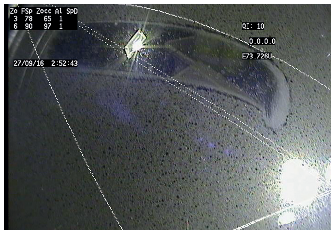
Figure 16 : Mauvaise qualité d'image issue d'une caméra dont la vitre de caisson est encrassée
