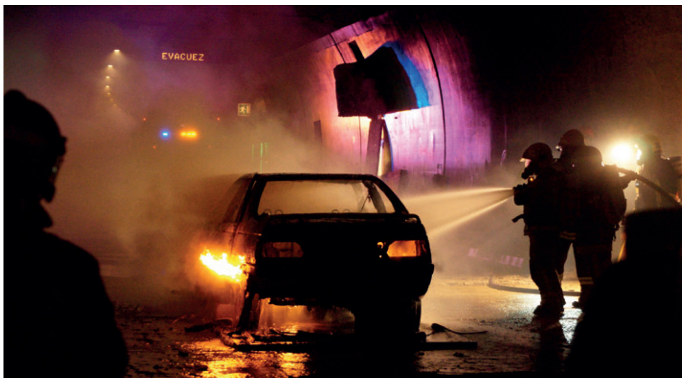
Tunnel de Saint-Béat – Essai incendie (© CETU)
