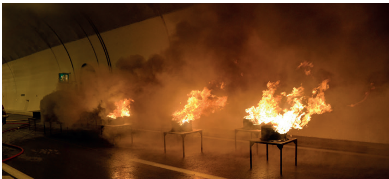
Tunnel de Talant – Essai incendie (© CETU)
