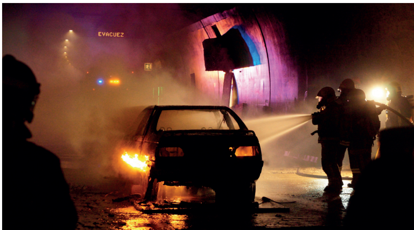
Tunnel de Saint-Béat – Essai incendie (© CETU)
