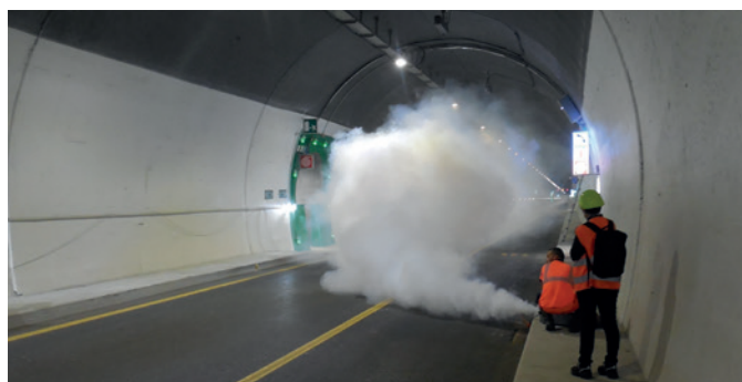
Tunnel de Tende – Essai incendie (© CETU)
