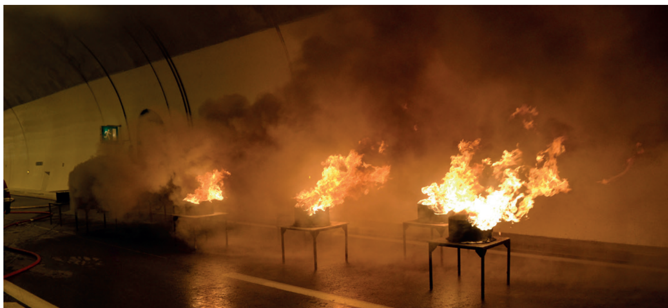
Tunnel de Talant – Essai incendie (© CETU)
