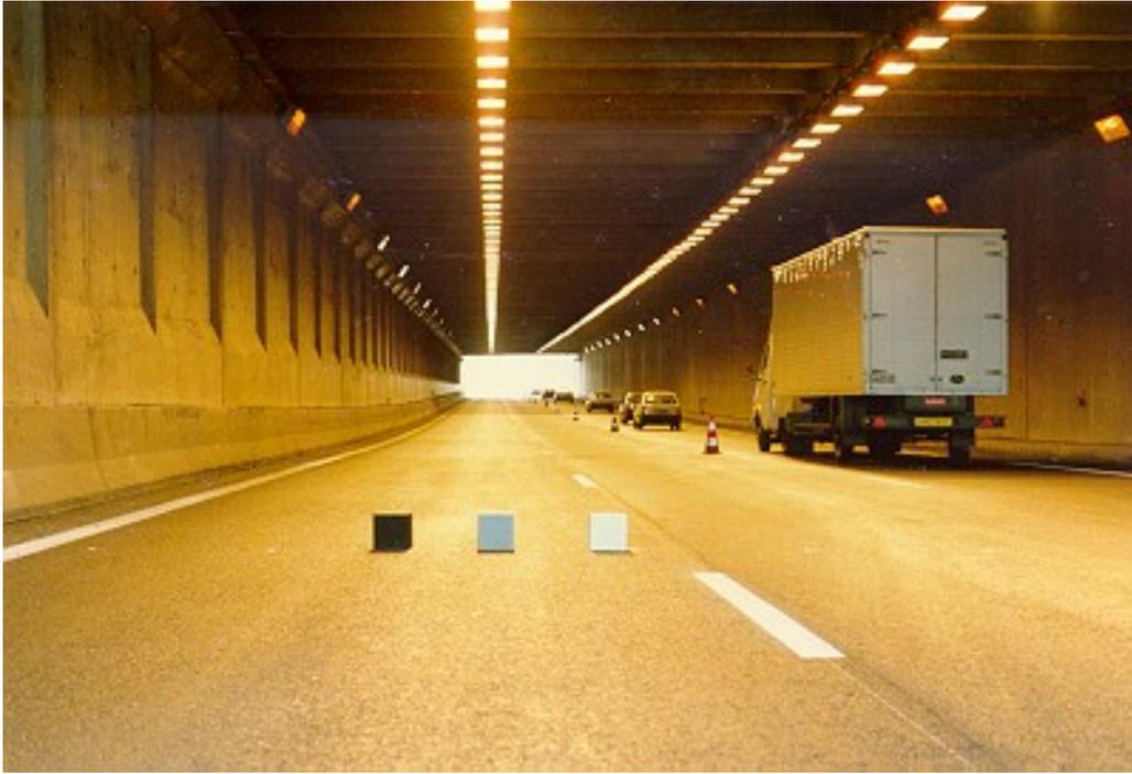
photo n°2: Détection de cibles posées au sol.
