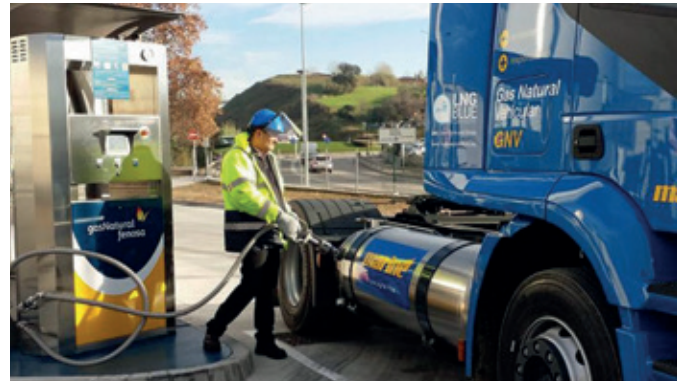
Figure 17 : Remplissage d'un réservoir de poids lourd GNL
