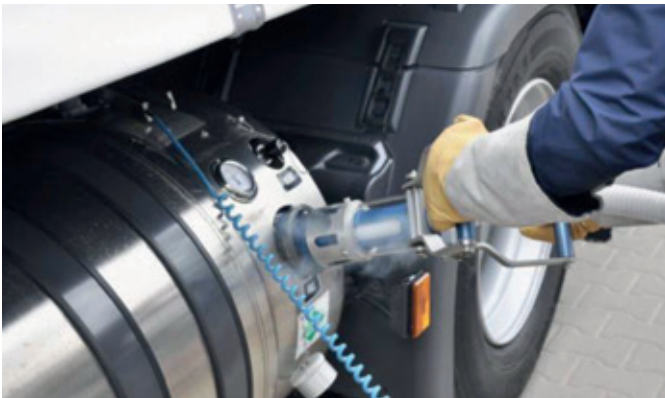
Figure 10 : Réservoir GNL sur un poids lourd
