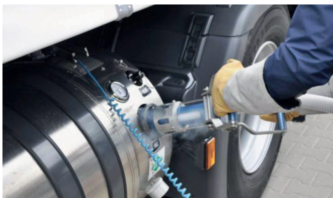
Figure 10 : Réservoir GNL sur un poids lourd
