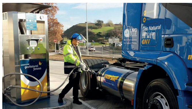
Figure 17 : Remplissage d'un réservoir de poids lourd GNL
