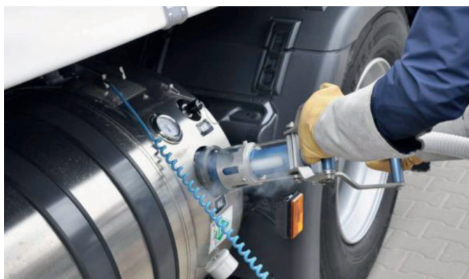
Figure 10 : Réservoir GNL sur un poids lourd
