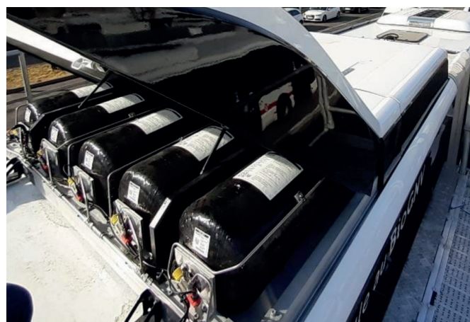
Figure 16 : Réservoirs GNC sur un bus
