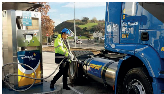
Figure 17 : Remplissage d'un réservoir de poids lourd GNL
