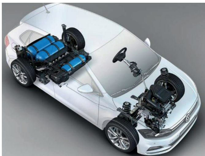
Figure 4 : Schéma d'un véhicule GNC
