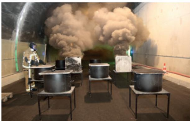
Essais avec des fumées – Tunnel de la Gâtine
