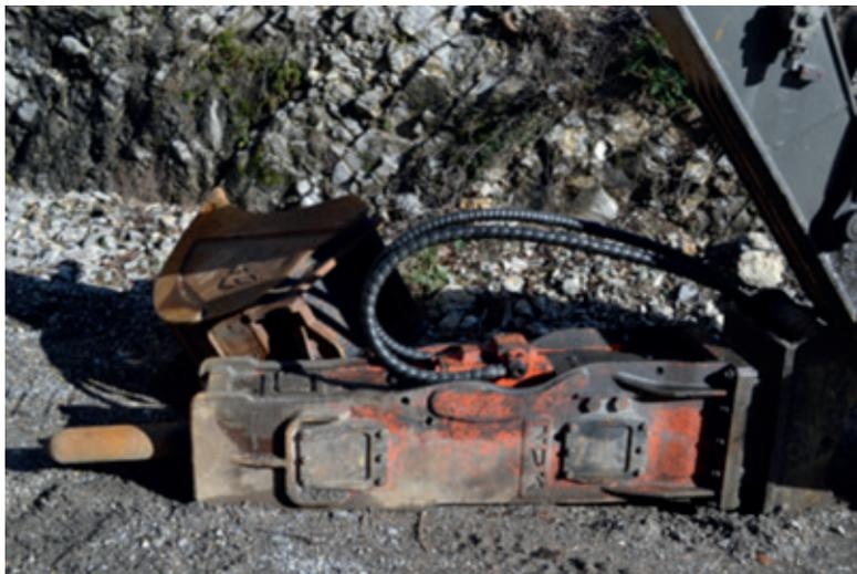
Illustration 20 : Tunnel des Échelles – Alésage au BRH et vue détaillée d'un BRH
